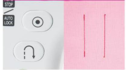
Permet de coudre des points de surfilage au début et à la fin de la couture. Il existe 2 types de points de surfilage : les points de retour et les points renforcés.
