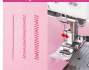
Permet de régler à la fois la taille des points et la position de l'aiguille.
