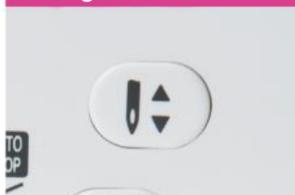
Permet de changer la position de l'aiguille instantanément ou sa position d'arrêt en appuyant sur le bouton due à son effet.
