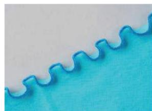
**Roulotté 3 fils avec ajustement différentiel**
