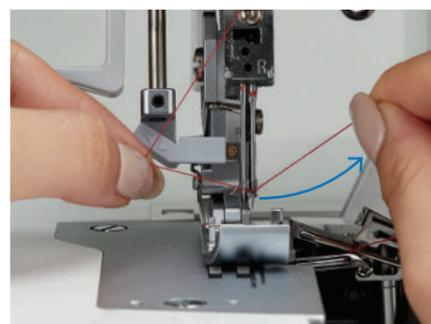
L'enfilage automatique des aiguilles (Fils aiguilles droit et gauche)
