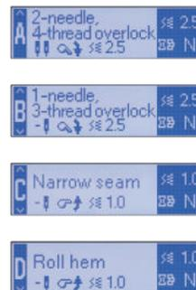
En réglant le bouton de changement de point sur A à D, l'écran LCD affiche quelles aiguilles sont utilisées pour chaque type de point sélectionné, ainsi que tous les paramètres.
