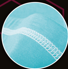
Point de recouvrement à 4 fils
