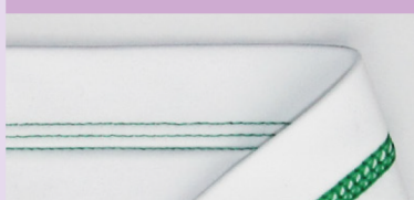
Point de recouvrement à 4 fils
